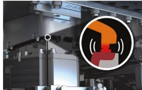
Lors du soudage par vibration propre, l'une des surfaces à assembler est préchauffée (gauche) pour réduire au maximum la quantité de vibrations requise pour achever le soudage (droite). Les soudures sont plus propres et le risque d'endommagements sur l'électronique fragile est réduit au maximum.
