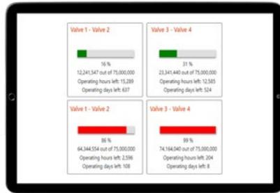
Las soluciones de software de Emerson proporcionan una supervisión del ciclo de vida de las válvulas de vapor con análisis diseñados para predecir los fallos antes de que se produzcan. Esto permite adoptar estrategias de mantenimiento preventivo para avisar al equipo de mantenimiento de cuándo se deben sustituir las válvulas, lo que evita un curado de bajo rendimiento que genera un costoso desguace de neumáticos en las fases finales y la pérdida de producción.
