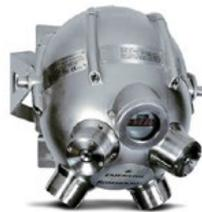
Il sistema di rilevamento delle perdite di gas a ultrasuoni avanzato Incus di Emerson utilizza quattro sensori acustici ultrasensibili per monitorare costantemente vaste aree e rilevare gli ultrasuoni generati dal rilascio di gas pressurizzato. È ideale per il monitoraggio di ambienti esterni ben ventilati, come la stazione di rifornimento.
