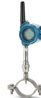
La tecnología Rosemount X-well proporciona datos de temperatura de proceso exactos sin necesidad de penetrar la tubería de proceso. Funciona midiendo las temperaturas ambiente y superficial de la tubería para calcular la temperatura de proceso mediante un algoritmo de conductividad térmica. X-well ofrece una instalación sencilla con diversos tamaños y materiales de la abrazadera para proporcionar una solución eficaz para un amplio rango de temperaturas.
