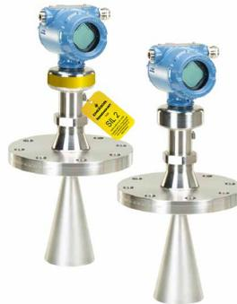
Un transmisor de nivel por radar sin contacto aprobado por 3-A, utiliza tecnología avanzada y un diseño orientado al usuario para proporcionar mediciones exactas y fiables de materiales líquidos y sólidos. Emplea la tecnología de onda continua de frecuencia modulada (FMCW) de dos hilos y usa un eco continuo para maximizar la intensidad de la señal de radar y generar una medición más robusta y fiable.
