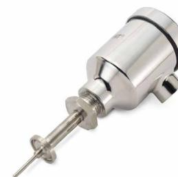
Una termorresistencia estándar de la industria. Este sensor está diseñado para ofrecer mediciones de temperatura flexibles y fiables en entornos de proceso higiénicos para la industria láctea. Esta termorresistencia está diseñada con una configuración de tapa final sanitaria Tri Clamp® para una instalación sencilla y su conexión de proceso aséptica es adecuada para aplicaciones de medición de limpieza in situ (CIP), sin bolsas inertes.
