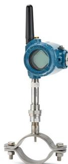
La tecnología Rosemount X-well proporciona datos de temperatura de proceso exactos sin necesidad de penetrar la tubería de proceso. Funciona midiendo las temperaturas ambiente y superficial de la tubería para calcular la temperatura de proceso mediante un algoritmo de conductividad térmica. X-well ofrece una instalación sencilla con diversos tamaños y materiales de la abrazadera para proporcionar una solución eficaz para un amplio rango de temperaturas.
