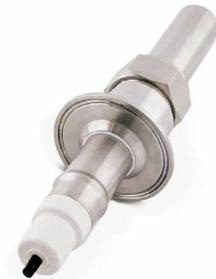
Este sensor está equipado con un transistor de efecto de campo selectivo a iones (ISFET) como electrodo de pH que proporciona una medición estable del pH. Su velocidad de respuesta puede ser 10 veces más rápida que la de los electrodos de vidrio, por lo que permite un mejor control del proceso. Su breve tiempo de respuesta y mayor estabilidad permite unos intervalos más largos entre calibraciones y mantenimiento del sensor.
