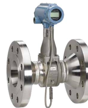
Su diseño único ofrece una fiabilidad de máximo nivel, con un cuerpo sin juntas a prueba de obstrucciones que elimina puntos de fuga potenciales, logrando una disponibilidad máxima del proceso. Los sensores están aislados, por lo que se elimina la necesidad de romper sellos de proceso para la sustitución de los sensores de caudal y temperatura.
