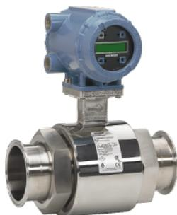
El Rosemount 8721 emplea un cuerpo del medidor totalmente soldado que está diseñado para aplicaciones de procesamiento de lácteos que requieren un funcionamiento seguro, higiénico y fiable. Todas las superficies de contacto están construidas en materiales aprobados por la FDA y diseñados según las normas 3-A y EHEDG. Está disponible con diversas conexiones para procesos sanitarios con juntas de proceso de fácil acceso para propiciar una inspección y un mantenimiento eficientes.
