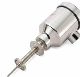
Una termorresistencia estándar de la industria. Este sensor está diseñado para ofrecer mediciones de temperatura flexibles y fiables en entornos de proceso higiénicos para la industria láctea. Esta termorresistencia está diseñada con una configuración de tapa final sanitaria Tri Clamp® para una instalación sencilla y su conexión de proceso aséptica es adecuada para aplicaciones de medición de limpieza in situ (CIP), sin bolsas inertes.
