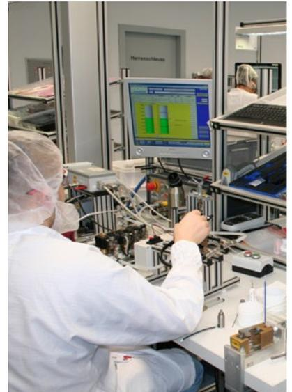
Nos solutions d'ingénierie sont fabriquées dans un environnement équivalent à une salle blanche de classe 8 afin de minimiser les risques de contamination et d'éviter d'avoir à retravailler les pièces.
