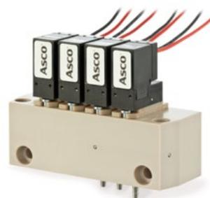
Cette solution personnalisée composée de quatre vannes d'isolement ASCO série 067 montées en batterie sur un manifold en PEEK contrôle les réactifs dans un instrument d'immunodosage.
