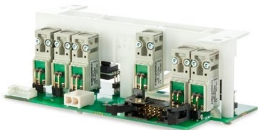
Un module unique régule le niveau de liquide dans le dialyseur de l'appareil à hémodialyse.
