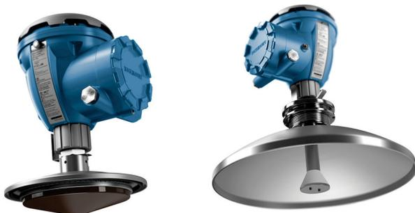
Радарные уровнемеры Rosemount серии 5900 с параболическими антеннами предназначены также для тяжелых условий эксплуатации, например для резервуаров с битумом. [Рисунок 11](#) Антенна на рисунке остается в рабочем состоянии после того, как в течение нескольких месяцев подвергалась воздействию жидкого битума при температуре 220 °С (430 °F).
