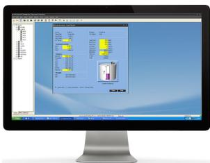
Rosemount TankMaster — это мощный, простой в использовании пакет программного обеспечения для управления запасами на базе Windows™, который собирает данные об измерении резервуара в режиме реального времени, такие как уровень, температура, уровень границы раздела фаз и давление воды.
