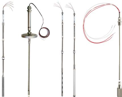
3- или 4-проводные калиброванные температурные датчики и измерение уровня свободной воды. До 16 точечных элементов Pt-100 на датчик/измерительный преобразователь. Для измерения температуры продукта могут применяться только полностью погруженные элементы. Каждый датчик подключен к измерительному преобразователю Rosemount 2240S.
