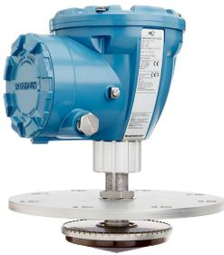
Rosemount 5900C — это надежный радарный уровнемер с погрешностью  $\pm 1$  мм (0,04 дюйма). Как правило, уровнемер используется в сочетании с системой многоточечных датчиков температуры для расчета объема. Он сертифицирован по уровню SIL 2 по стандарту МЭК 61508.
