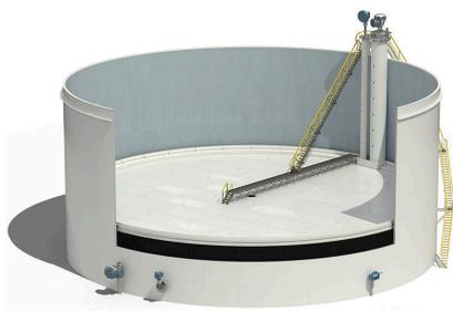
Резервуар с плавающей крышей
