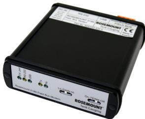
Модем полевой шины Rosemount 2180 используется для подключения полевых преобразователей Rosemount или системного концентратора Rosemount 2460 по шине TRL2 к рабочей станции Rosemount TankMaster на посту управления. Модем подключается к ПК с помощью интерфейса RS232 или USB.
