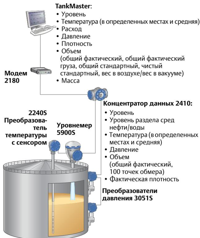
Конфигурация системы учета Rosemount Tank Gauging включает средства измерения уровня, температуры и давления для высокоэффективного вычисления массы, плотности, объема и измерения уровня
