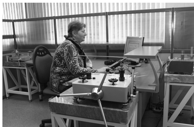
Представитель Челябинского ЦСМ проводит поверку калибратора давления
