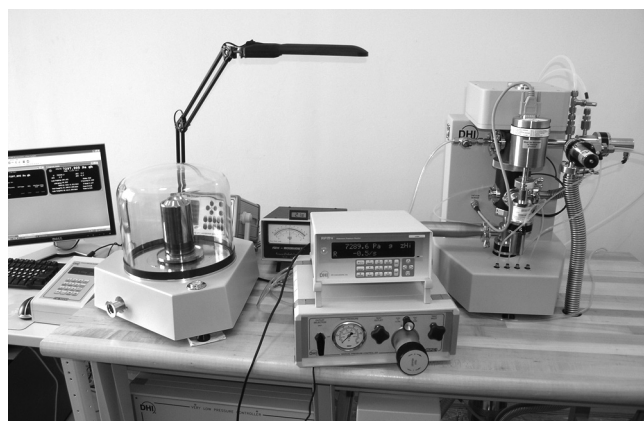
Грузопоршневые калибратор давления PG7601 и компенсационный манометр FPG8601 в работе
