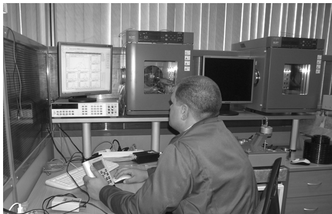
Калибровка портативных калибраторов давления Метран-517 и эталонных модулей давления Метран-518
