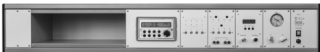
Рис.1 Пример внешнего вида блока функциональных панелей для поверки 1-4-х датчиков давления и 1-4-х манометров (в т.ч. электроконтактных) с автоматизированным (автоматическим) заданием давления и разрежения (базовое исполнение).
